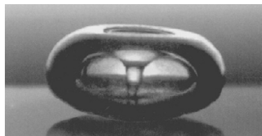
Figure A.2.4 : Implosion d'une bulle de cavitation (dont le diamètre est de l'ordre de 1 mm) à 10 Hz à proximité d'une surface rigide, photographie réalisée par L. Crum [176] .
