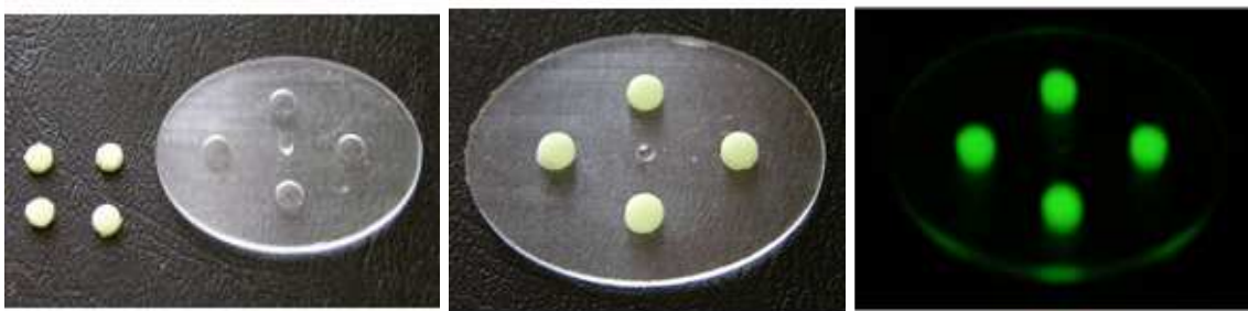
FIGURE 2 : Réalisation par procédé de hot embossing d'un composant à propriétés luminescentes localisées.
