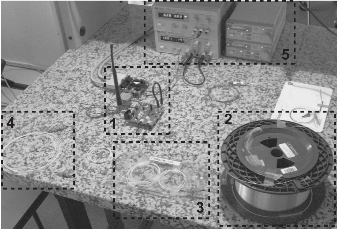
FIG. 3.19 – Photographie du montage expérimental de l'oscillateur chaotique
