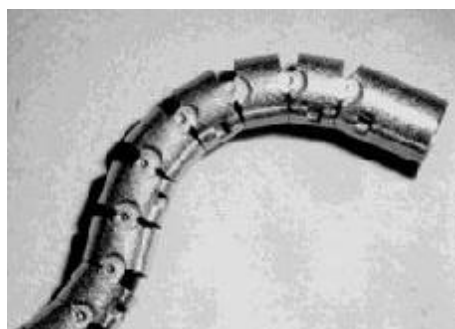
2.6 - Sonde d'endoscopie - diam. ext. 2,8 mm - [Oga98]
