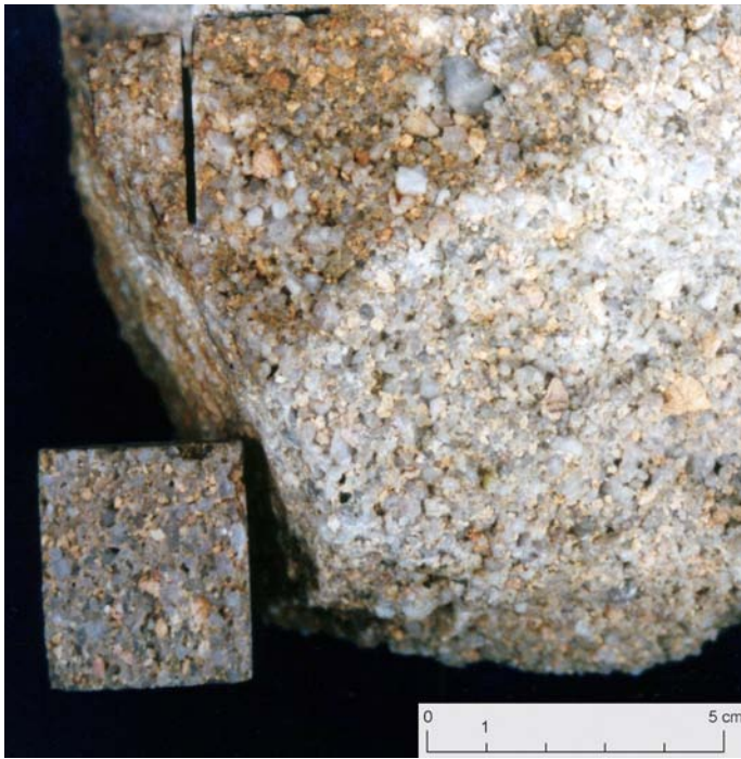
Figure 110 : arkose du massif de la Serre (échantillon M12). Le bloc échantillonné sur la commune de Moissey est altéré en surface. Découpe pour lame mince : X. Invernizzi, cliché P. Pétrequin
