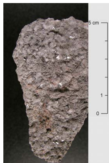
Figure 97 : leucogranite de CH 4 phase 1, n° 1411 13 : a) photo à l'œil n, b) lame mince, LN c) lame mince, LP. Le minéral le plus frappant dans ce granite est la muscovite, brillante à l'œil nu et de taille très importante, de l'ordre de deux à trois millimètres sur le cliché de la lame mince (minéral coloré)
