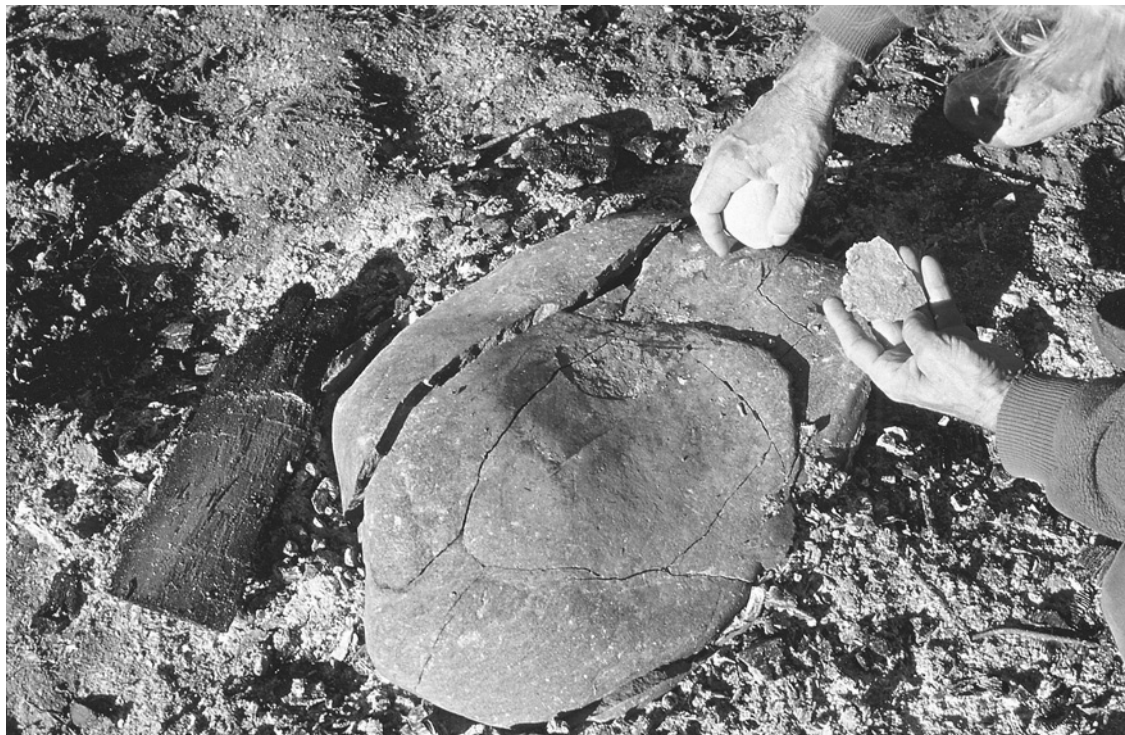
Figure 41 : éclatement thermique expérimental : galet de glaucophanite de la Durance. Temps de chauffe 1h30, montée en température très rapide (de 0 à 800°C en 10 minutes). Cliché A.-M. Pétrequin, expérimentation octobre 2006
