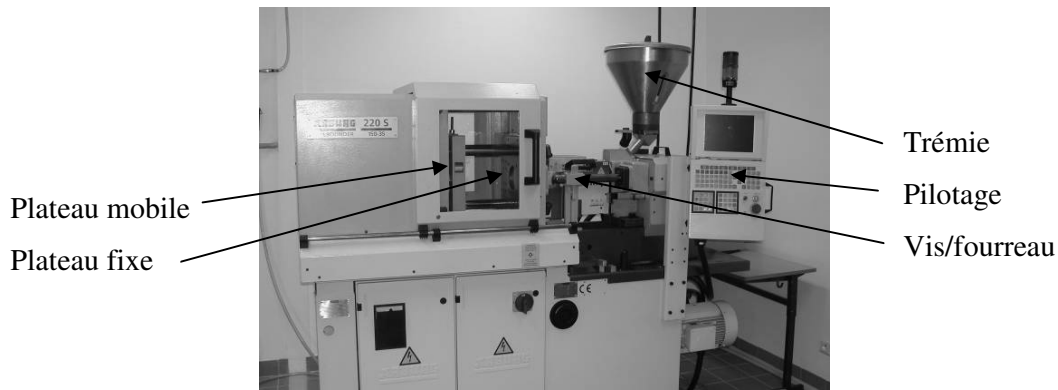
Figure 48. Presse de micro-injection (Volume injectable de 3 à 12 cm 3 ).
