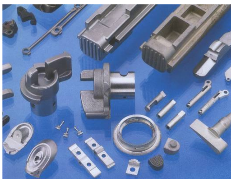
Figure 1. Composants réalisés par Moulage par Injection de poudres Métalliques (MIM) [ALL 08].
