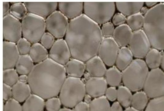
Figure 34 : Gouttelettes d'huile piégées dans les lamelles d'une mousse (Telmadarrie et Trivedi, 2018).
