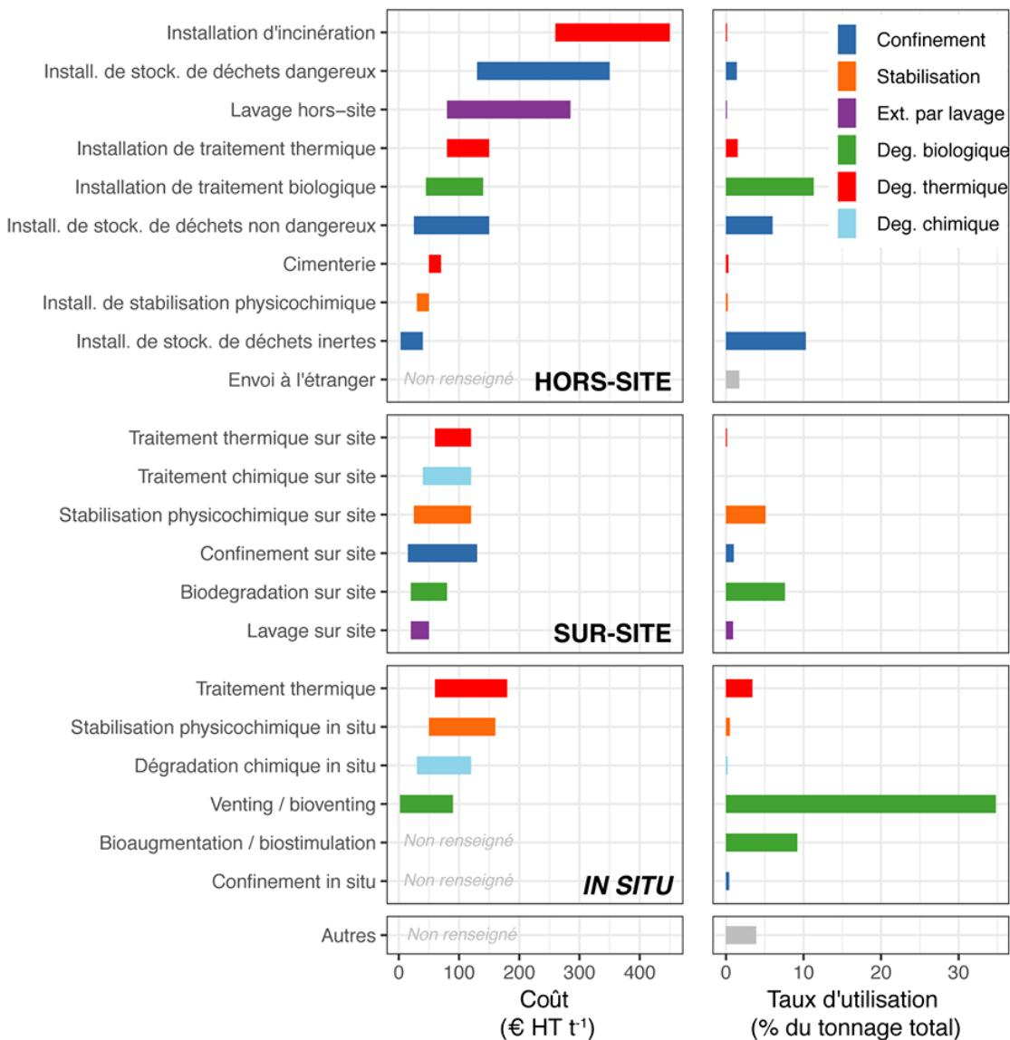
Figure 15 : Coûts et taux d'utilisation de différentes filières de traitement des sols en France (données extraites d'ADEME, 2014a et de Colombano *et al.*, 2010).
