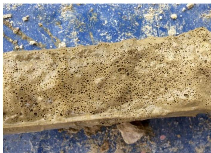
Figure 49 : Échantillon de sol 3 semaines après l'injection de mousse montrant la présence de bulles de gaz (Maire *et al.*, 2018c).
