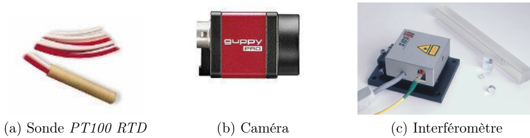
FIGURE 3.5 – Exemples d'instruments qui peuvent être utilisés pour surveiller les MEMS.
