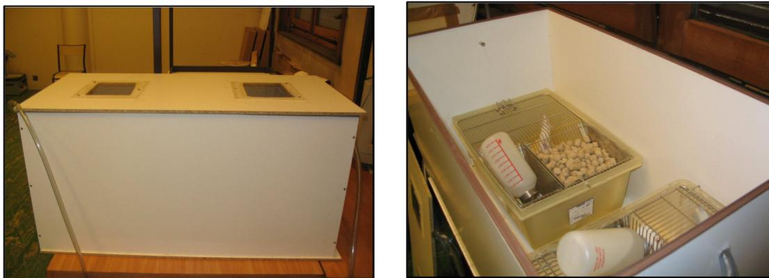
**Figure 40:** A gauche : enceinte d'exposition ; à droite : installation des cages à l'intérieur de l'enceinte lors des expositions.
