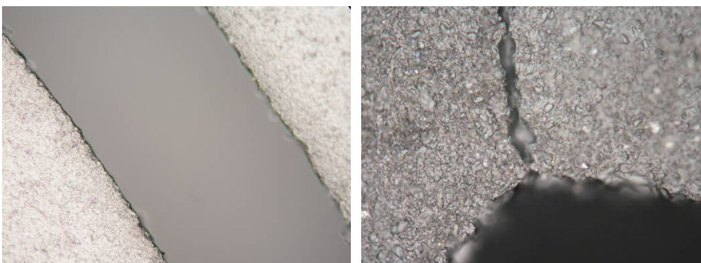
Fig. 19 A gauche : bord du découpage ultrason sur un résonateur LGT, à droite : fissure de la couronne dans le coin de l'usinage sur un résonateur LGT.
