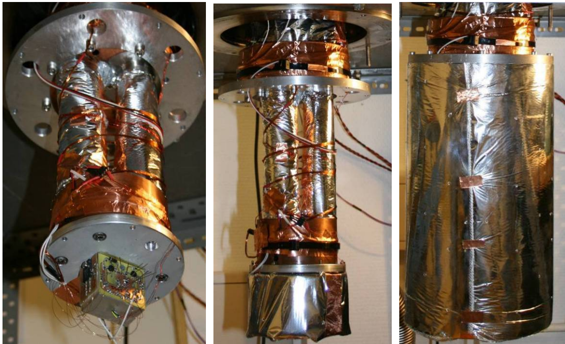
Fig. 50 Sur la photo de gauche aucun écran antiradiation n'est en place. Sur la photo du centre, celui de l'oscillateur est en place. Sur celle de droite, celui du deuxième étage est en place.
