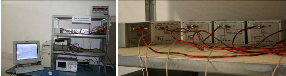
Fig. 64 A gauche : banc de mesure de vieillissement. A droite : les 5 oscillateurs en test.
