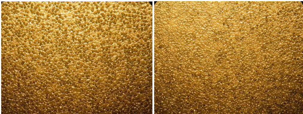
Fig. 13 Lame 1 face 2, rodage de 50\ \mu\text{m} au carbure de Si \varnothing 7\ \mu\text{m} vue au microscope ( \times 50 ) et lame 2 face 1, rodage de 100\ \mu\text{m} au carbure de Si \varnothing 7\ \mu\text{m} vue au microscope ( \times 50 ) ; après 8 H acidage au bifluorure d'ammonium à 80^{\circ}\text{C} .
