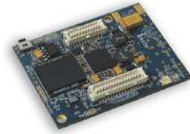
FIG. 3.3 – Nœud capteur Imote2 sans batteries.
